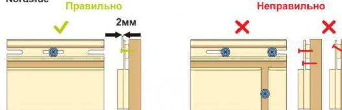
При монтаже фасадной панели не вкручивайте саморез до упора. Расстояние от шляпки самореза до панели должно быть 2 мм.
