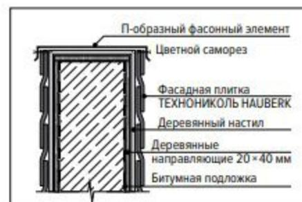
Рис. 11.2. Монтаж фасадной плитки на подпорную стенку. Вариант 2
