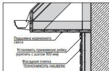
Рис. 9.2. Монтаж верхнего ряда под карнизным свесом. Вариант 2
